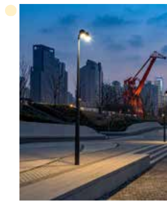
LICHTMAST (OLIVIO CANDELABRA) / AFM: Ø163MM, HOOGTE 4,50M / LEVERANCIER SELUX / TYPE: SX 764EE6 / INCL DIM REGIME / 2700 KELVIN EEN ARMATUUR PER MAST
